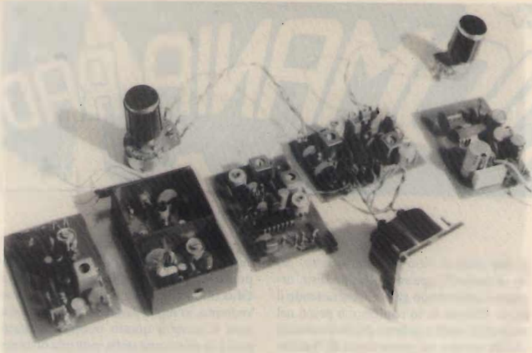
I cinque moduli del ricevitore "Rho Ophiuchi" prima di essere assemblati in un unico circuito.
